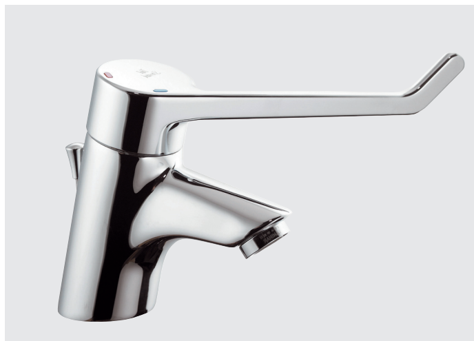
Einhebel-Waschtischsicherheitsarmatur DN 15 mit starrem Gussauslauf und vandalsicherem Laminarstrahlregler mit Zugknopf-Ablaufgarnitur G 1 1/4 \" und Drehsicherheitskartusche (öffnet rechts drehend über kalt nach warm)
