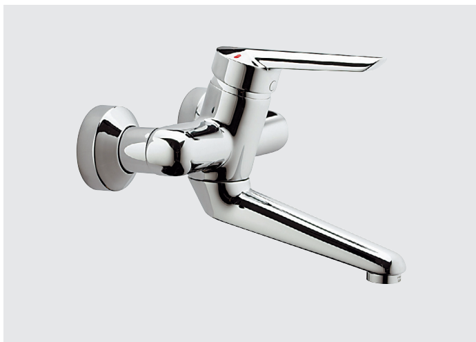
Einhebel-Wand-Waschtischarmatur DN 15 mit dreifach einstellbarem Gussauslauf (fixiert, nicht fixiert, +/- 45° fixiert), mit vandalensicherem Laminarstrahlregler, Schubrosetten und geräuschgedämpften S-Anschlüssen
