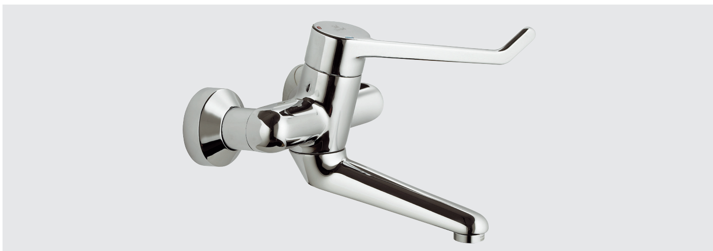
Einhebel-Wand-Waschtischsicherheitsarmatur DN 15 mit dreifach einstellbarem Gussauslauf (fixiert, nicht fixiert, +/- 45 ° fixiert), mit vandalsicherem Laminarstrahlregler, Schubrosetten mit absperbaren, geräuschgedämpften, verdeckten S-Anschlüssen und Drehsicherheitskartusche (öffnet rechts drehend über kalt nach warm)
