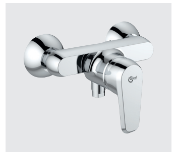
Einhebel-Brausearmatur AP DN 15, mit Rückflussverhinderer, DVGW-eigensicher
