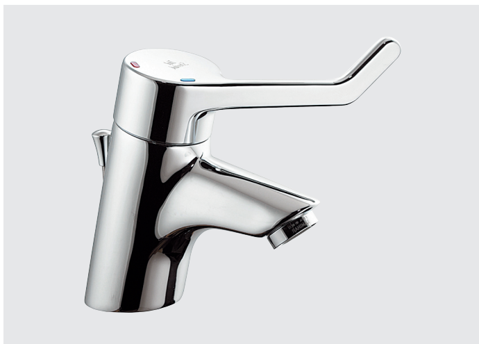
Einhebel-Waschtischsicherheitsarmatur DN 15 mit starrem Gussauslauf und vandalsicherem Laminarstrahlregler mit Zugknopf-Ablaufgarnitur 1 1/4 \" und Drehsicherheitskartusche (öffnet rechts drehend über kalt nach warm)
