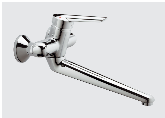
Einhebel-Wand-Waschtischarmatur DN 15 mit dreifach einstellbarem Gussauslauf (fixiert, nicht fixiert, +/- 45° fixiert) mit vandalensicherem Laminarstrahlregler, Schubrosetten und geräuschgedämpften, verdeckten S-Anschlüssen
